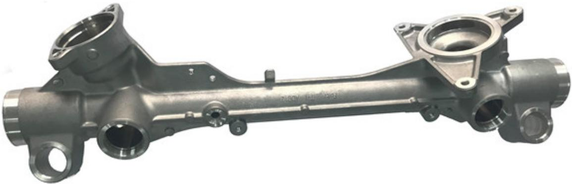
按传能介质的不同，动力转向器有气压式和液压式两种。装载质量特大的货车不宜采用气压动力转向器，因为气压系统的工作压力较低(一般不高于)，用于重型汽车上时，其部件尺寸将过于庞大。液压动力转向器的工作压力可高达10MPa以上，故其部件尺寸很小。液压系统工作时无噪声，工作滞后时间短，而且能吸收来自不平路面的冲击。因此，液压动力转向器已在各类各级汽车上获得广泛应用。根据机械式转向器、转向动力缸和转向控制阀三者转向装置中的布置和联接关系的不同，液压动力转向装置分为整体式(机械式转向器、转向动力缸和转向控制阀三者设计为一体)、组合式(把机械式转向器和转向控制阀设计在一起，转向动力缸分开)和分离式(机械式转向器分开，把转向控制阀和转向动力缸设计为一体)三种结构型式。江苏机械式转向器多少钱转向器，就选上海神富机械科技有限公司，有需要可以联系我司哦！
